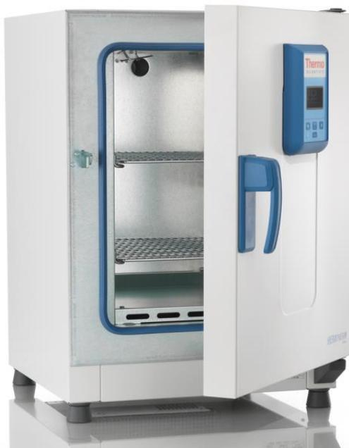
Сухожаровые шкафы Thermo Scientific серии Heratherm предназначены для работы в различных лабораториях (от промышленных до научно-исследовательских и учебных), где используются для стерилизации посуды и инструментов, сушки, контроля качества, проведения испытаний на старение и прочность материалов. Сухожаровые шкафы производятся как с естественной циркуляцией воздуха (модели OGS / OGH), так и с принудительной вентиляцией (модели OMS / OMH).
