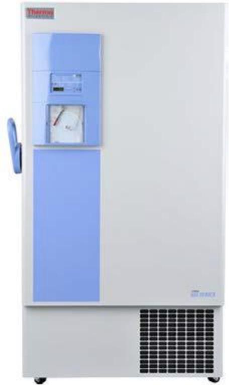
***Морозильник вертикальный однодверный серии Forma 900, 368л, температурный диапазон: от  $-50^{\circ}\text{C}$  до  $-86^{\circ}\text{C}$ , 3 полки, 4 внутренних двери.***
