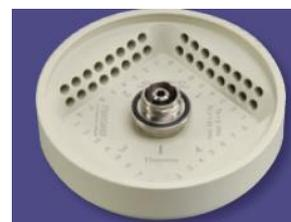
Ротор 36 x 0,5 мл с навинчивающейся крышкой увеличивает пропускную способность для небольших микропробирок
